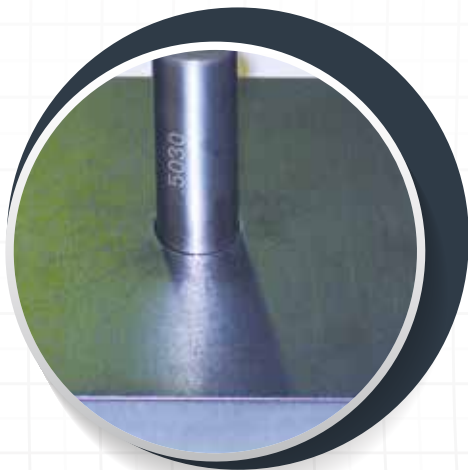
■ Schneiden mit der HPRXD Plasma und der True Hole Technologie
